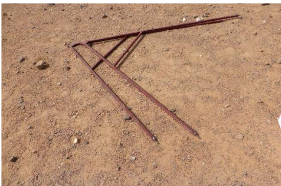
Compas de traçage du demi-cercle de la demi- lune à Akoubounou-Tahoua (A.K. SABRA)
