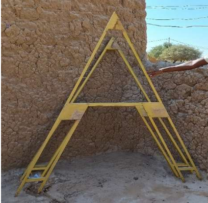
Compas de traçage du demi-cercle de la demi-lune à Akoubounou-Tahoua (A.K. SABRA)
