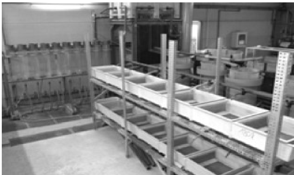
Écloserie en circuit fermé pour la production d'alevin de Clarias gariepinus : dans le fond, batterie de bouteilles de Zoug au-dessus du filtre bactérien pour l'éclosion des œufs et château d'eau et à l'avant plan, bacs de larviculture avec leurs clais (Photo Tropicultura, 2003)
